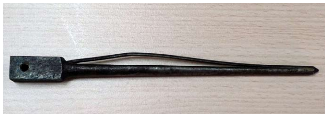
Broca de llançadora forjada a mà
