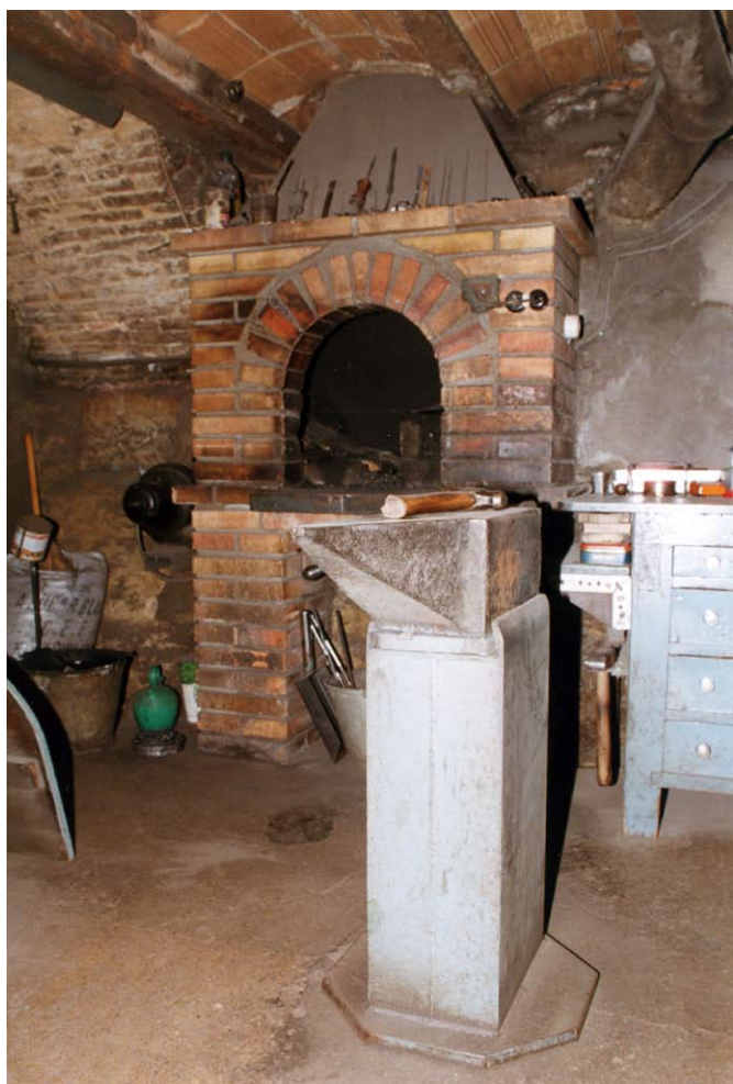
Fornal i enclusa on es forjaven i es donava el tremp a les fulles dels ganivets
